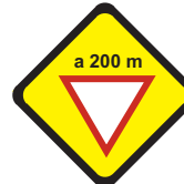
P 33(b) PROXIMIDAD DE SEÑAL RESTRICATIVA(paso)
