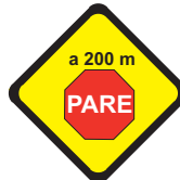
P 33(a) PROXIMIDAD DE SEÑAL RESTRICATIVA(pare)
