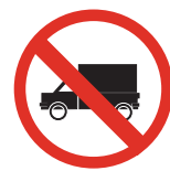
R 3 (4) PROHIBICIÓN DE CIRCULAR (camión)
